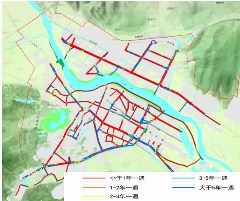
图 10. 当阳管网勘测数据库与管网能力评估
